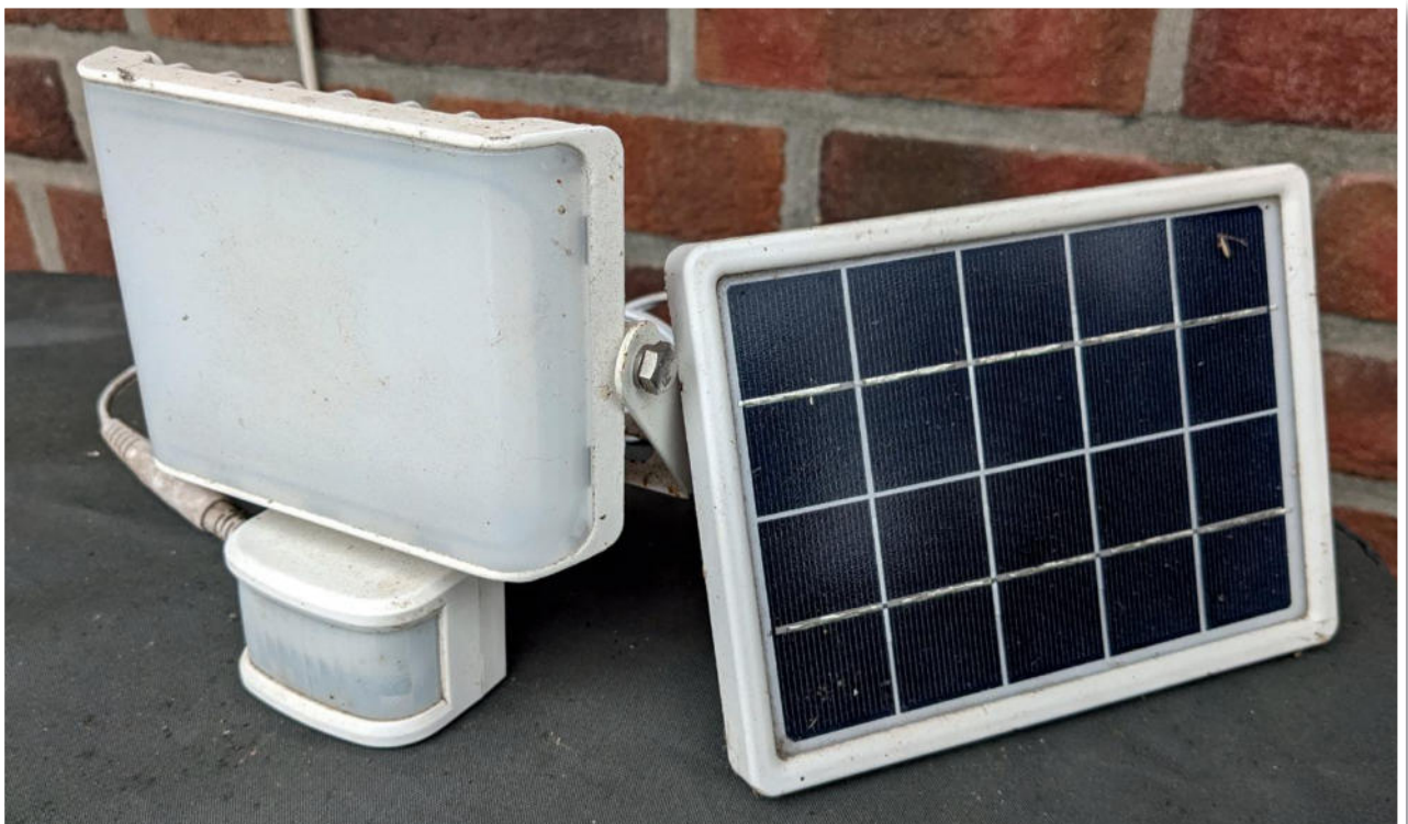
Lampen mit Bewegungsmelder und kleiner Solarzelle kommen an verschiedenen Stellen im Innen- und Außenbereich, an denen jeweils nur für kürzere Zeit Licht nötig ist, zum Einsatz. Die Solarzelle muss immer an einem sonnenreichen Ort angebracht werden.
